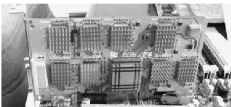
图3: PCI E-1X接口的采集卡插在PCI-E 1X插槽上
